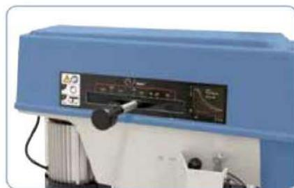
El ajuste de las revoluciones se realiza de forma continua mediante una palanca en el cabezal de la máquina
