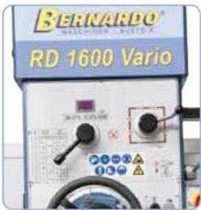
El ajuste de las revoluciones deseadas o del avance deseado se realiza en el lateral frontal del cabezal de taladrar.
