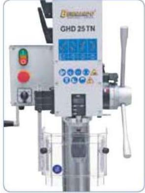
Disposición intuitiva de los botones y elementos de mando en el cabezal de engranaje
