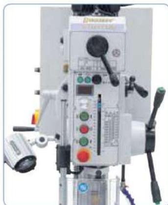
Preselección fácil de la marcha mediante engranaje intermedio. Ajuste de las revoluciones deseadas mediante potenciómetro
