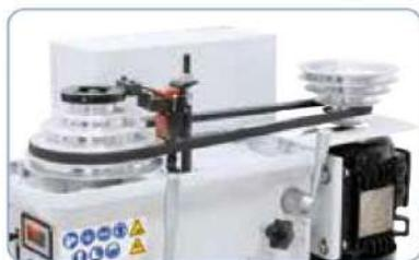
Poleas de fundición gris equilibradas para un funcionamiento muy silencioso. Las correas trapecoidales de alta calidad se encargan de proporcionar una transmisión óptima de la fuerza.
