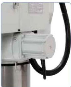
Motor hidráulico de serie para sujeción por apriete del brazo y del cabezal.
