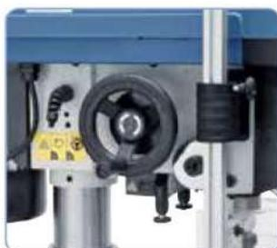
Volante posicionado lateralmente para el ajuste de las revoluciones deseadas
