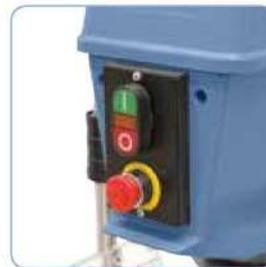
Botón de encendido y apagado conforme a IP 54 y botón de parada de emergencia de acuerdo con la normativa de la CE
