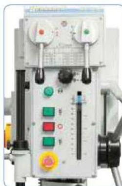
Elementos de conmutación y de operación dispuestos de forma vistosa en la parte frontal de la máquina.
