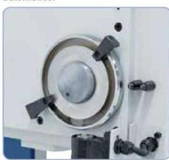
Mecanismo para roscar con inversión del sentido de giro. Ideal para fabricación en serie (de KBM 50).
