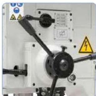
El avance de broca puede realizarse manualmente o con avance mecánico (0,1/0,2/0,3 mm/r).
