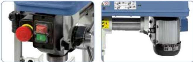
Botón de encendido y apagado conforme a IP 54 y botón de parada de emergencia independiente
