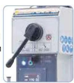
Para un trabajo preciso, la máquina viene equipada de serie con un avance de broca automático y una luz de trabajo, así como un indicador de profundidad de taladrado digital.
