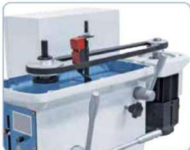
Poleas de fundición gris equilibradas para un funcionamiento muy silencioso. Las correas trapezoidales de alta calidad se encargan de proporcionar una transmisión óptima de la fuerza.
