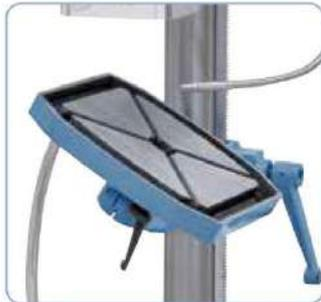
La mesa de trabajo maciza con ranuras en T dispuestas en diagonal es inclinable de  $-45^\circ$  a  $+45^\circ$
