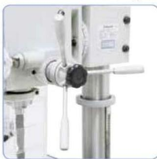
El movimiento de la caña se realiza mediante manetas ergonómicas
