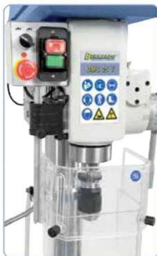
Elementos de conmutación y de operación dispuestos de forma vistosa Opcional: Portabrocas sin llave 1-16 mm / B 18.
