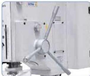
El avance de taladrado se puede realizar manualmente o mediante acoplamiento electromagnético
