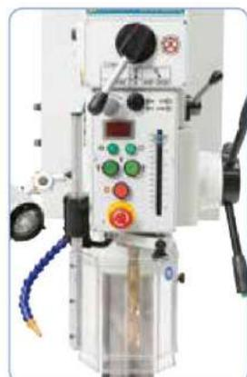
Preselección fácil de la marcha mediante engranaje intermedio. Ajuste de las revoluciones deseadas mediante potenciómetro.
