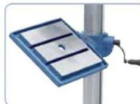
La mesa de taladrado se puede inclinar de  $-45^\circ$  a  $+45^\circ$  y girar  $360^\circ$  alrededor de la columna.
