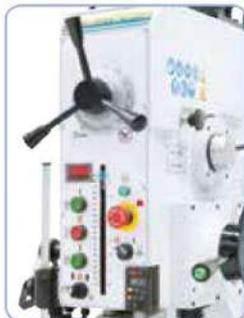
Cabezal de engranaje macizo con botones y elementos de operación dispuestos de forma ergonómica. Los indicadores digitales para ajuste de profundidad de taladrado y revoluciones vienen de serie.
