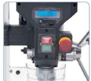
Botón de encendido y apagado conforme a IP 54 y botón de parada de emergencia de acuerdo con la normativa de la CE
