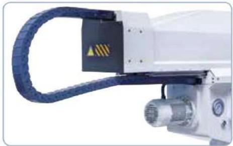
Motor para instalación hidráulica y cadena de suministro de energía en el dorso de la máquina.
