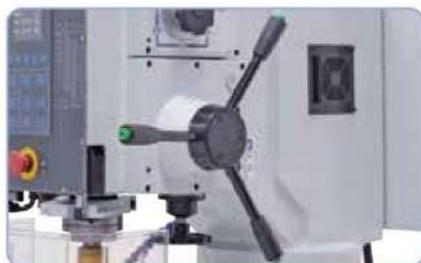
El avance de taladrado se puede realizar manualmente o mediante acoplamiento electromagnético
