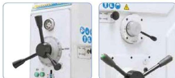
Cambio de revoluciones fácil y rápido mediante palancas de embrague.
