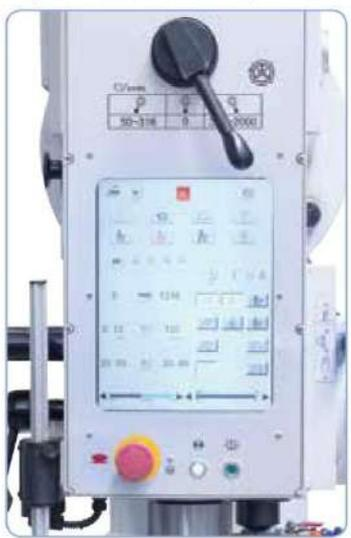
Pantalla táctil de grandes dimensiones que permite realizar todos los ajustes, p. ej. revoluciones, taladrado / roscado, ajuste de altura del brazo radial, etc.
