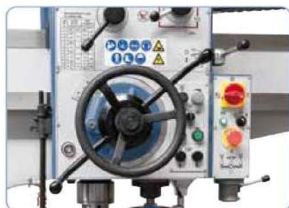
La caña puede bajarse de 3 formas: rápido mediante palanca manual, preciso mediante volante o con avance automático.
