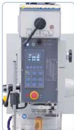
Cabezal de engranaje macizo con botones y elementos de operación dispuestos de forma ergonómica. Los indicadores digitales para ajuste de profundidad de taladrado y revoluciones vienen de serie
