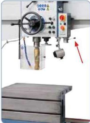
El cambio de sentido de giro o el acoplamiento y desacoplamiento del husillo se realizan mediante botón piloto situado en la parte inferior del cabezal de taladrar
