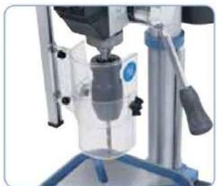
Cubierta de protección conforme a la normativa de la CE ajustable a la longitud de taladrado
