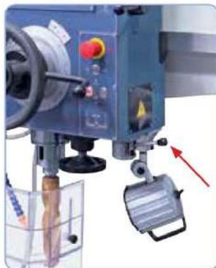
El cambio de sentido de giro o el acoplamiento y desacoplamiento del husillo se realizan mediante botón piloto situado en la parte inferior del cabezal de taladrar
