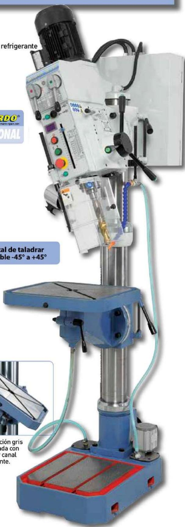
**Cabezal de taladrar inclinable -45° a +45°**
