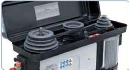
Discos de accionamiento de fundición gris equilibrados para un funcionamiento muy silencioso. Las correas trapezoidales de alta calidad se encargan de proporcionar una transmisión óptima de la fuerza.
