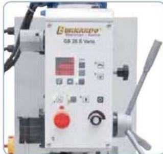
Preselección fácil de la marcha mediante engranaje intermedio. Ajuste de las revoluciones deseadas mediante potenciómetro
