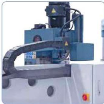
Contrapeso para la pinola y cadena de conducción de la energía en el dorso del cabezal de taladrar.
