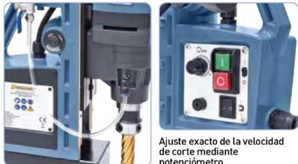
Ajuste exacto de la velocidad de corte mediante potenciómetro.
