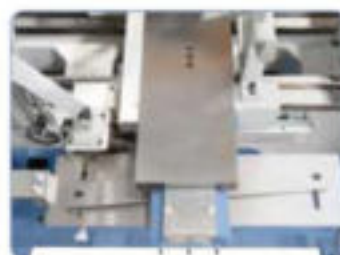
Dispositivo opcional de torneado cónico, longitud de mecanizado 455 mm, ángulo de ajuste \pm 8^\circ
