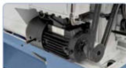
Potente motor principal con freno magnético conforme a la normativa de la CE
