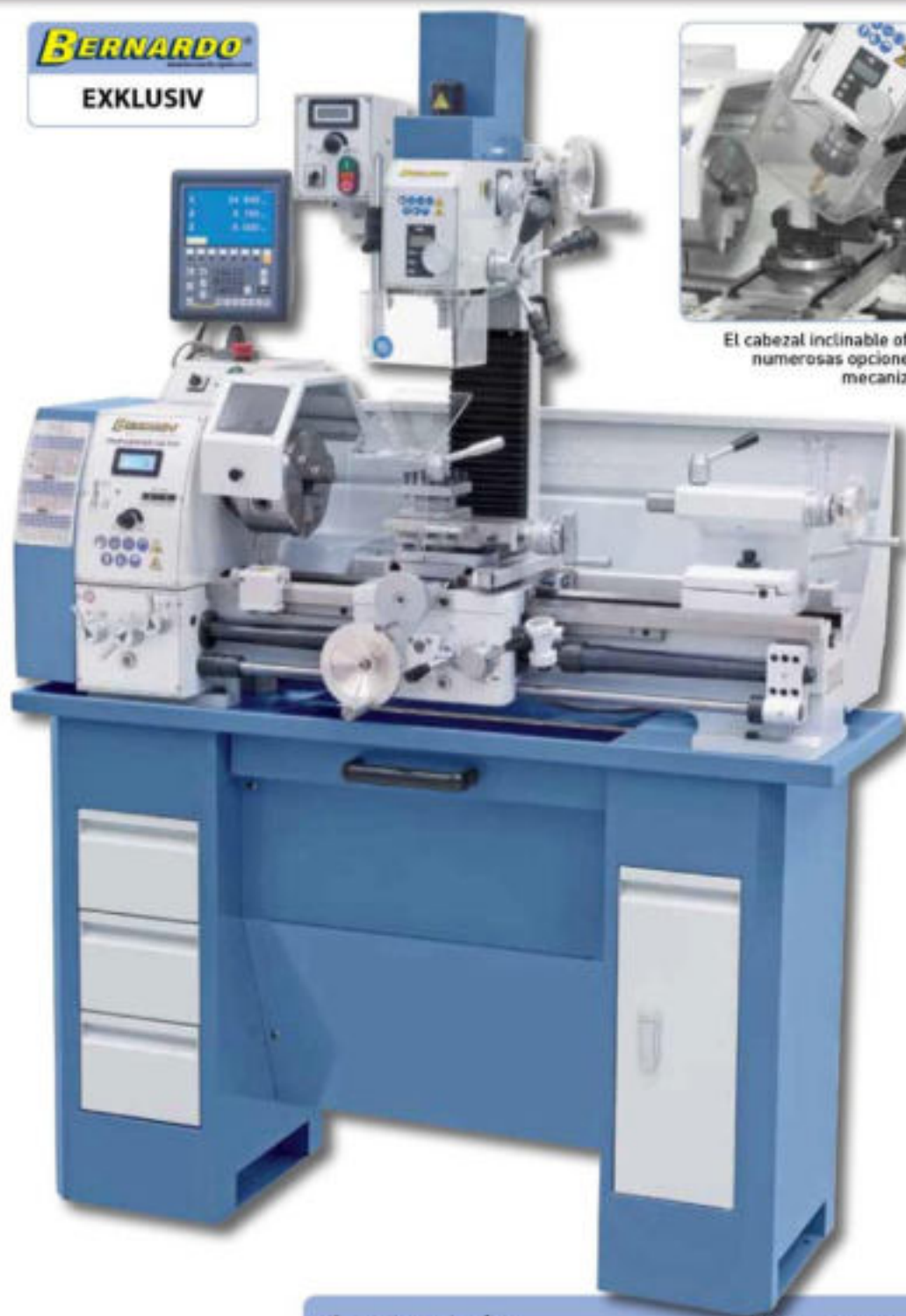
El contrapunto con fijación por palanca se puede desplazar lateralmente para torneado cónico, el punto giratorio para tubos es opcional.
