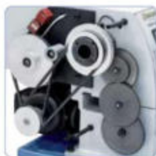
Sencillo ajuste de la gama de revoluciones mediante correa trapezoidal
