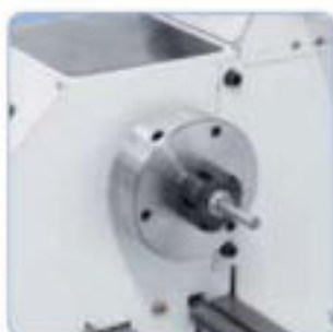
El portapinzas ER 25 asegura una alta concentricidad de amarre, pinzas desde 1 a 16mm.
