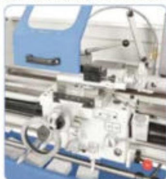
Dispone de 42 avances longitudinales y transversales
