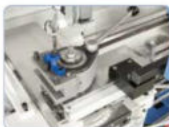
Para aumentar la eficiencia en el trabajo, la máquina está equipada de serie con un portahilos, de cambio rápido
