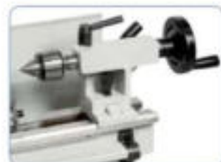
El contrapunto con CM 2 puede desplazarse para torneados cónicos
