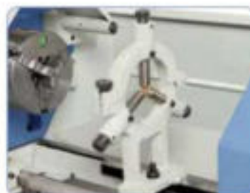
Luneta fija con guías de bronce para la sujeción de piezas de trabajo largas
