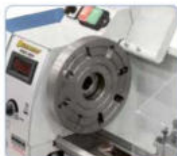
Para sujetar piezas de trabajo con forma especial, la máquina puede equiparse un plato liso de 170 mm.
