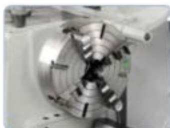
Plato de 4 garras independientes de 320 mm (opcional) ideal para el amarre de piezas asimétricas.
