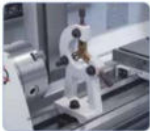
Luneta fija con dedos de bronce para evitar el pandeo de piezas largas y finas.
