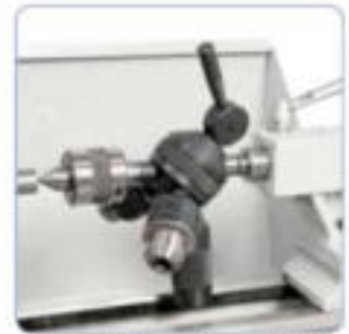
Para un trabajo más rentable, la máquina puede equiparse con una torreta portahtas.
