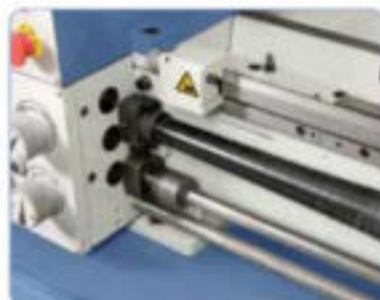
De serie con tope longitudinal micrométrico y embrague de seguridad
