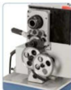
De serie con engranajes metálicos para el tallado de roscas métricas
