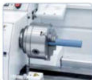
Plato de acero de 3 garras, interiores y exteriores incluido en el equipo base
