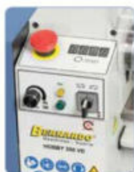
Regulación de revoluciones electrónica, fácil lectura mediante visualizador digital.
