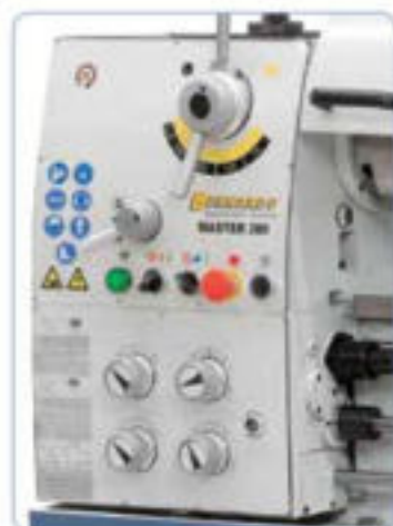
Regulación de revoluciones y de avances en el cabezal, funcionamiento silencioso gracias a ruedas dentadas templadas y rectificadas girando en baño de aceite
