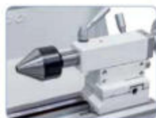
Punto giratorio diam. 60 mm. Ideal para sujetar tubos y piezas huecas (opcional)
