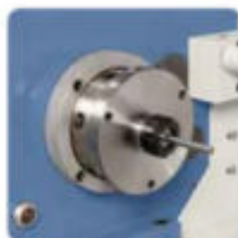
El portapinzas ER25 asegura una alta concentricidad de sujeción, entre 1 y 16 mm
