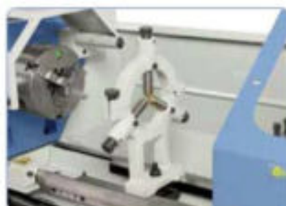
Luneta fija con guías de bronce para la sujeción de piezas de trabajo largas
