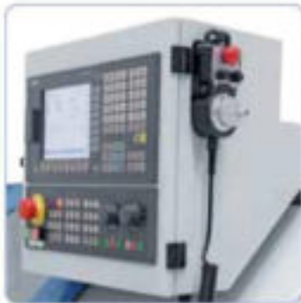
El control Siemens 808D Advanced viene de serie con numerosas funciones pre-programadas
