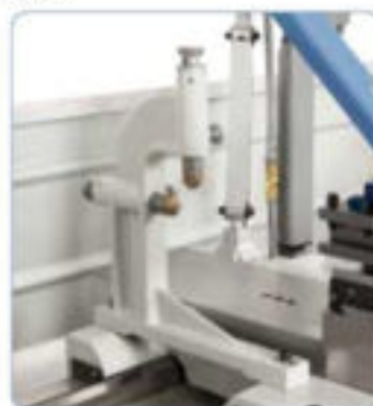
La luneta móviles impiden la flexión de ejes de pequeño diámetro.
