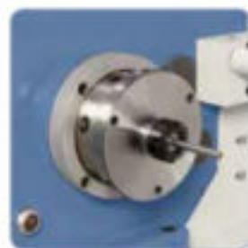
El portapinzas ER25 asegura una alta concentración de sujeción, entre 1 y 16mm
