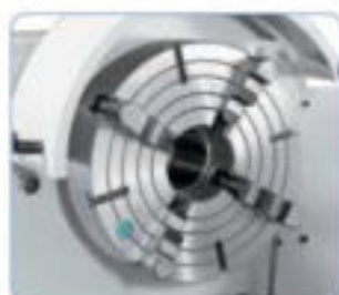
Opcional: Plato de 4 garras independ. de 400 mm, ideal para sujetar piezas irregulares
