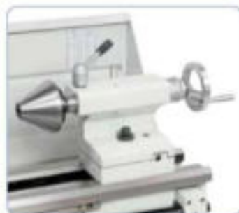
El contrapunto con fijación por palanca se puede desplazar lateralmente para torneado cónico, el punto giratorio para tubos es opcional.
