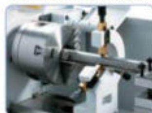
Luneta fija con guías de bronce para la sujeción de piezas largas.
