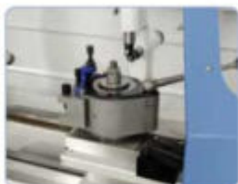
El portaherramientas de cambio rápido permite una reducción de tiempos muertos y garantiza una alta precisión de repetición.
