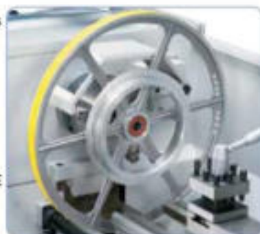
Escote desmontable para el mecanizado de piezas de hasta \phi 450 mm.
