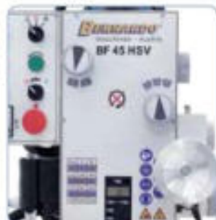
Indicador digital de profundidad para aumentar el confort en el trabajo
