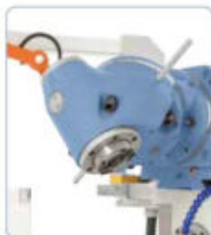
Cabezal portafresas universal con 2 ejes giratorios que se puede posicionar en todos los ángulos.
