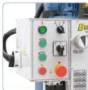
Mandos de control de fácil acceso (roscado, marcha/paro, etc.)
