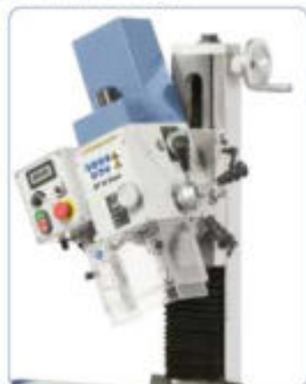
Cabezal inclinable a ambos lados +/-90°
