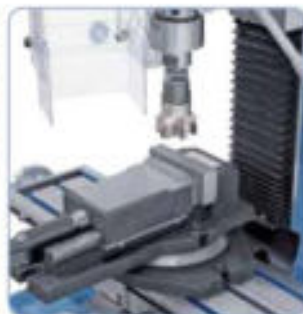
Fresado con fresa de planear y cantear (n.º ref. 42-1058)
