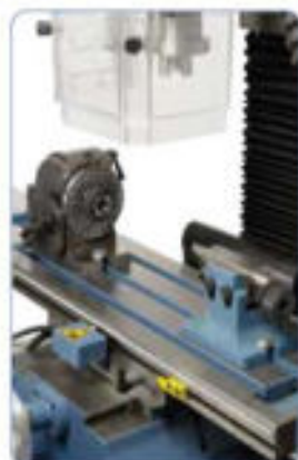
Divisor semi-universal BS-0 para el mecanizado de ejes.
