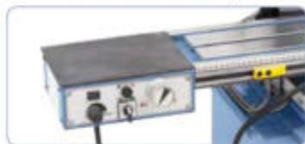
Opcional: Avance automático de la mesa, regulable continuamente. (Ref:02-1032/02-1033B)
