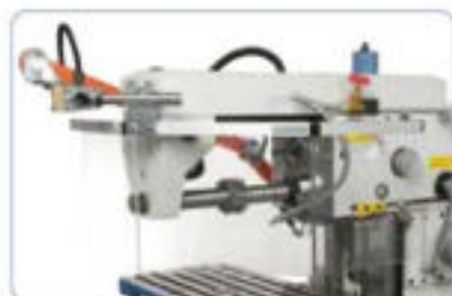
Fresado horizontal con contrasoporte
