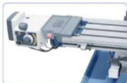
Avance automático AL 450 D regulable para un cómodo mecanizado [Art. nº 02-1117]
