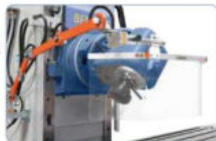
Cabezal portafresas universal con 2 ejes que se pueden posicionar en todos los ángulos
