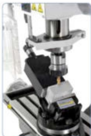
Fresado con mordaza inclinable y giratoria
