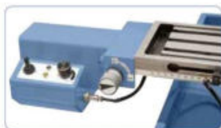
Mesa con avance automático regulable FTV 8.
