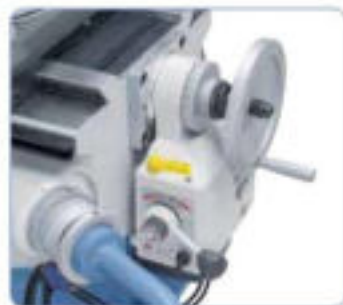
Motor de posicionamiento para ajuste de altura (eje z) de la mesa.
