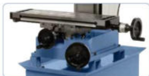
Sencillo ajuste del cabezal mediante volante situado en el frontal de la mesa.
