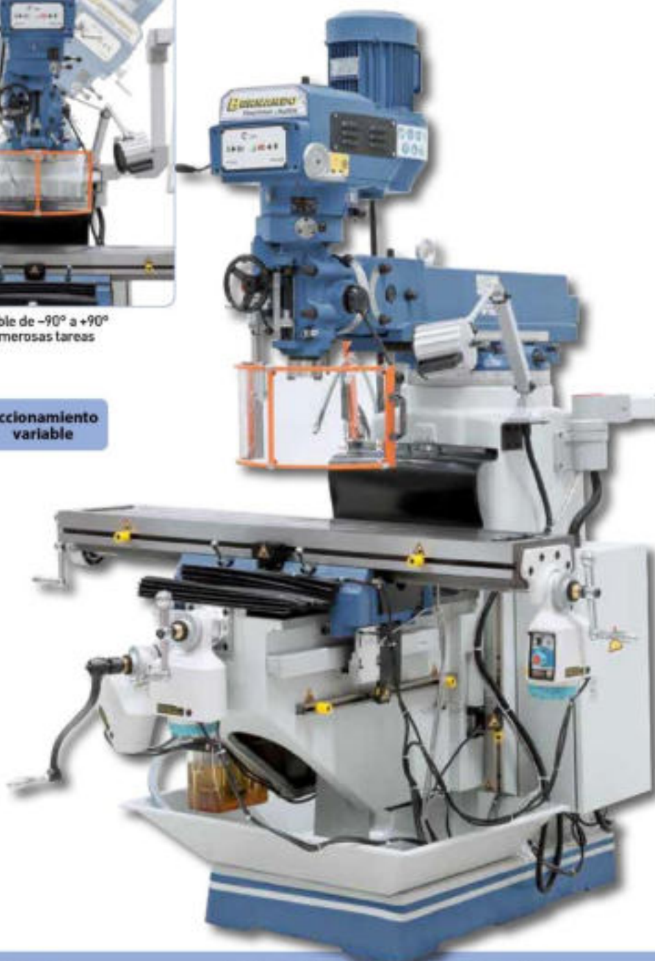
Lubricación central automática incluida en el equipo base
