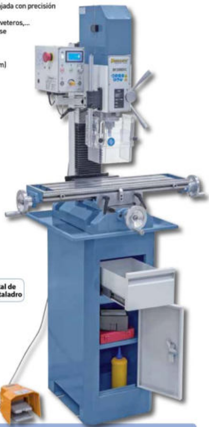
Indicador digital de revoluciones
