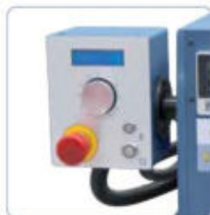
De serie con indicador de revoluciones digital y mecanismo para roscar
