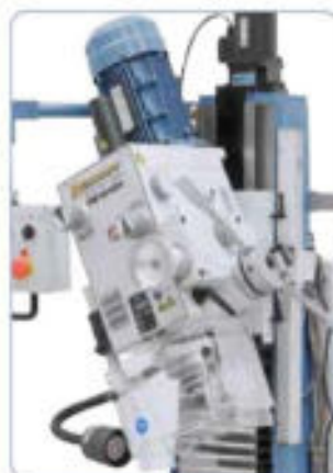
Cabezal portafresas inclinable en ambos lados de -60^\circ a +60^\circ
