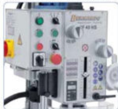
Elementos de conmutación y de operación dispuestos de forma vistosa en el cabezal de engranaje
