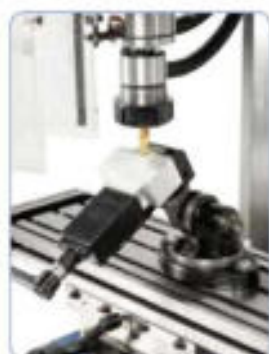
Fresado con tornillo de banco articulado PGS 50.
