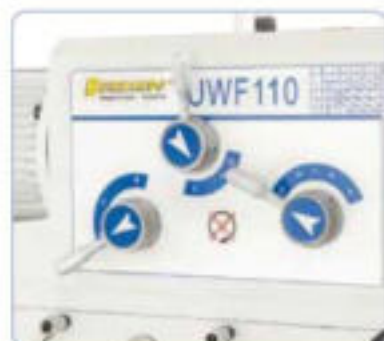
Sencillo uso de las palancas para cambio de revoluciones
