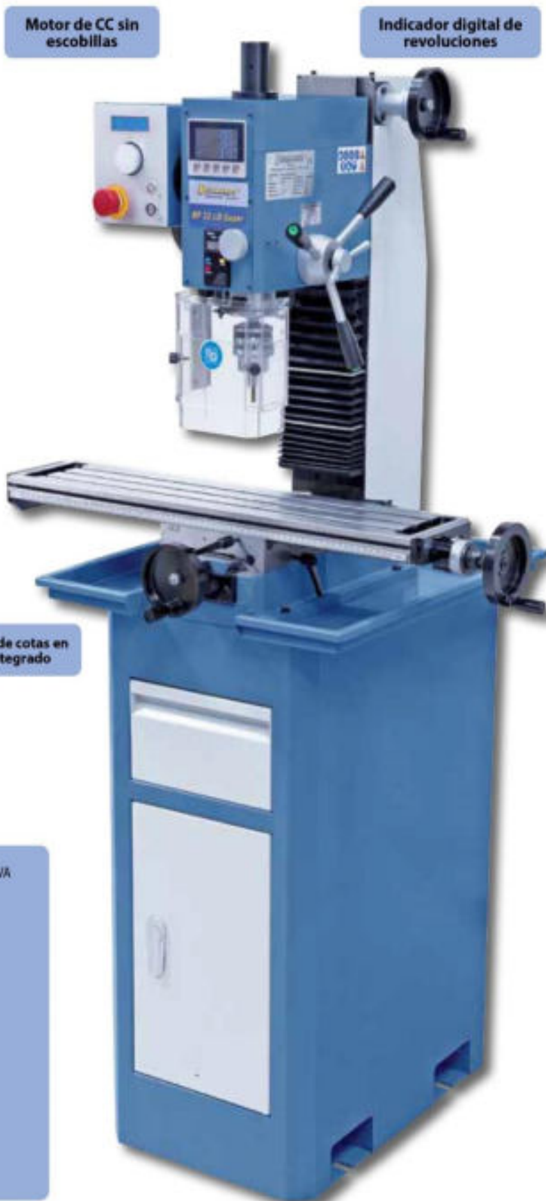
De serie: Indicador de posición de 3 ejes
