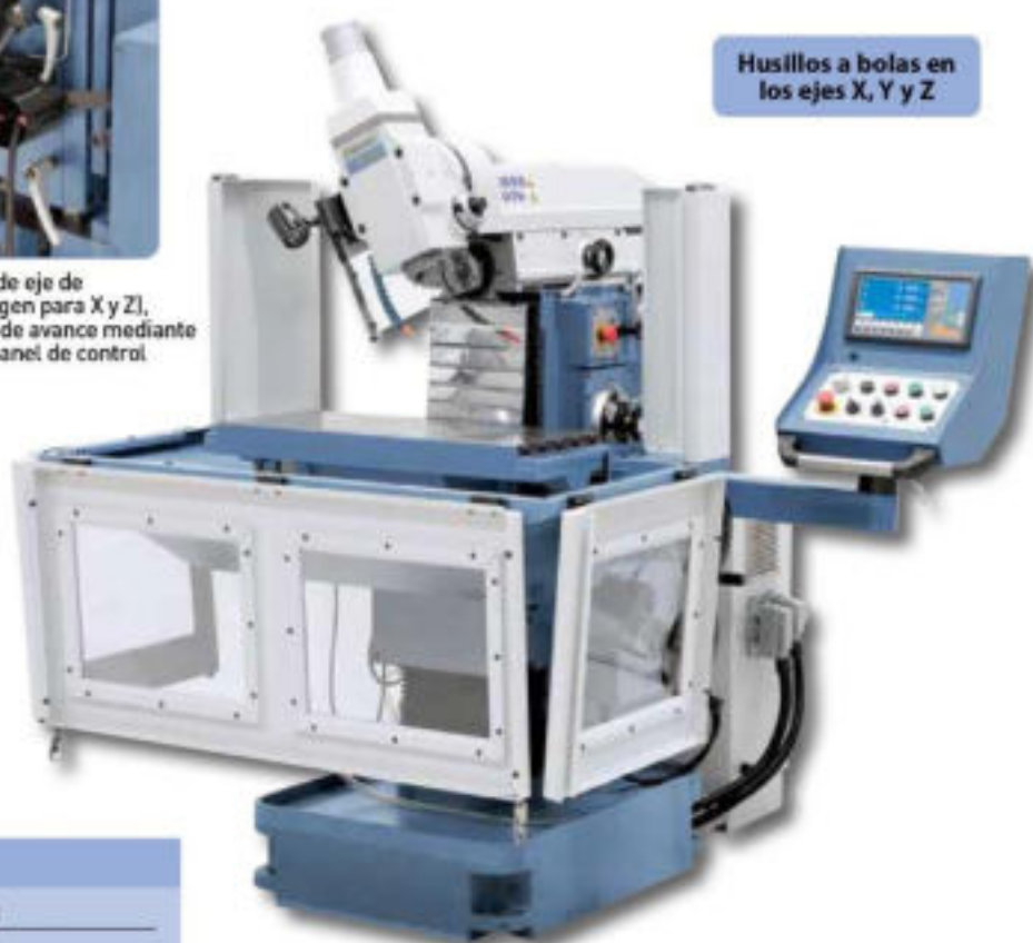
Elementos de control claramente dispuestos en la consola giratoria, de serie con visualizador de cotas LCD en 3 ejes
