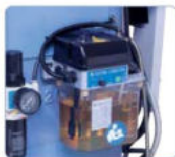
Lubricación central automática para las guías y los husillos
