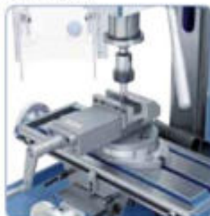
Disponible opcionalmente: fresa cilíndrica frontal con plaquitas reversibles de carburo
