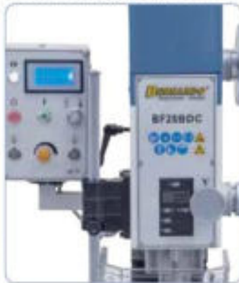
Indicadores de revoluciones y de profundidad de taladro digitales incluidos en la entrega
