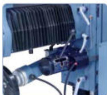
Palanca de selección de eje de movimiento (en la imagen para X y Z), ajuste de la velocidad de avance mediante potenciómetro en el panel de control
