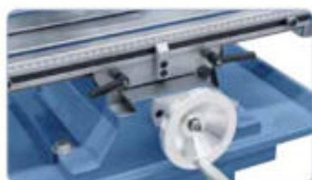
Guías en cola de milano ajustables con regletas en todos los ejes
