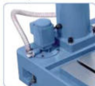
Bomba de refrigerante potente incluida en la entrega
