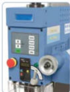
Indicadores digitales fáciles de leer, uso fácil mediante teclado de membrana.
