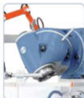
Cabezal portafresas universal ajustable para diferentes ángulos.
