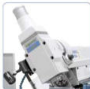
Cabezal vertical inclinable con movimiento manual de la pinola
