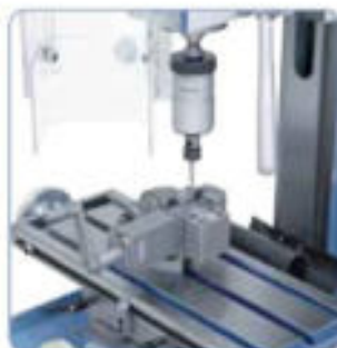
Para roscado la máquina se puede equipar con un aparato de roscar de M5 - M12.
