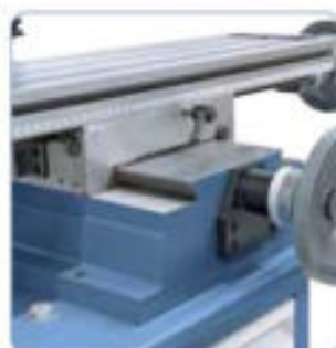
Guías en cola de milano ajustables con reglillas en todos los ejes
