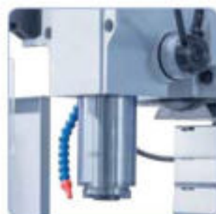
La pinola de grandes dimensiones garantiza el más alto grado de estabilidad
