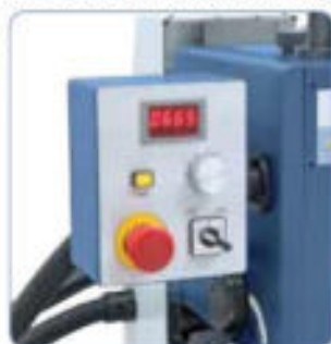
De serie con indicador de revoluciones digital y mecanismo para roscar
