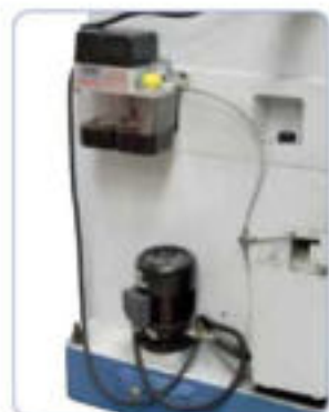
Lubricación central y sistema de refrigeración incluido en el equipo base
