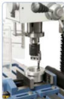
Si lo desea, la máquina se puede equipar con un cabezal de mandrinado.
