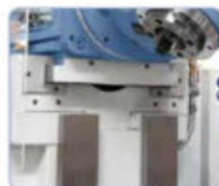
El diseño de la guía cuadrada de los ejes Y y Z garantiza un alto grado de estabilidad (FU 1600/FU 2000)
