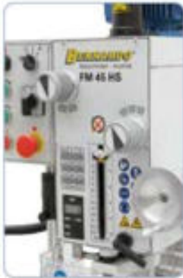
El cambio de revoluciones se consigue mediante un rápido cambio de engranajes
