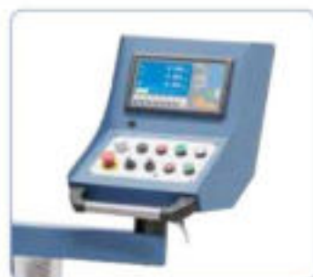
Elementos de control claramente dispuestos en la consola giratoria, de serie con visualizador de cotas LCD en 3 ejes
