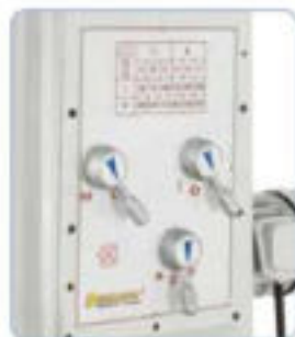
Situación clara y lógica de las palancas de cambio de revoluciones
