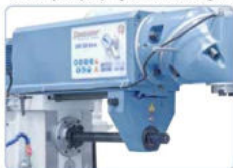
De serie con soporte y portafresas para fresado horizontal
