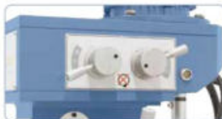
Clara posición de los mandos para un sencillo cambio de revoluciones
