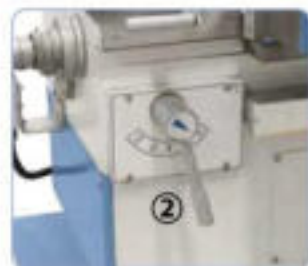
1: Palanca de selección de la dirección de avance 2: Palanca de selección de avance de eje
