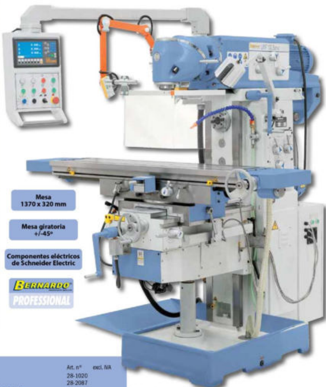
Cabezal portafresas universal con 2 ejes giratorios que se puede posicionar en todos los ángulos.
