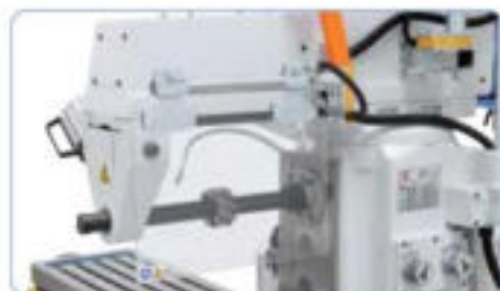
Para el fresado horizontal se incluye el soporte y el eje portafresas
