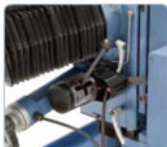
Palanca de selección de eje de movimiento (en la imagen para X y Z), ajuste de la velocidad de avance mediante potenciómetro en el panel de control
