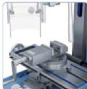
Fresado con mordaza de precisión PS 75
