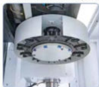
Cambiador automático de 12 herramientas con cambio rápido.
