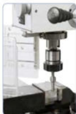
Accesorios especiales que pueden entregarse: Palpador de cantos
