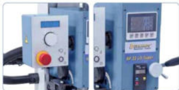
De serie con indicador de revoluciones digital y mecanismo para roscar
