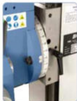
Guía de cola de milano que no requiere mantenimiento con regleta de cuña
