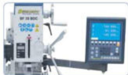
Se incluye un visualizador de cotas Bernardo ES-12 V en 3 ejes en el equipo base (Ref: 02-1117)
