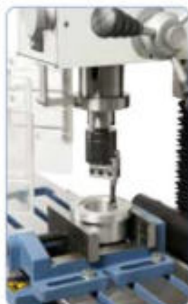
Si lo desea, la máquina se puede equipar con un cabezal de mandrinado.
