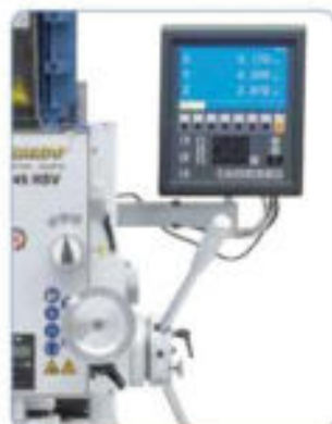
El visualizador de cotas LCD ES-12 V ofrece numerosas funciones como, por ejemplo, mecanizado de taladros, fresado de cajas, etc.
