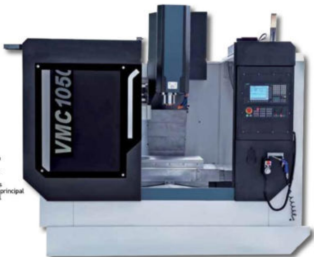
Cambiador automático de 16 herramientas con cambio rápido.
