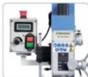
Indicadores de revoluciones y de profundidad de taladrado digitales incluidos en la entrega
