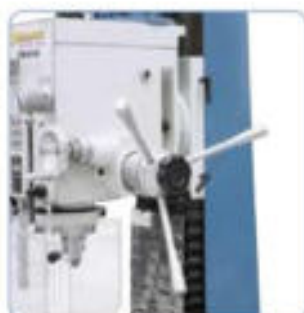
Ajuste fácil de la pinola a la hora de taladrar gracias a manijas dispuestas de forma ergonómica. Volante con escala para un ajuste preciso a la hora de fresar
