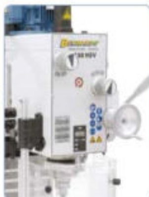
Cambio de revoluciones fácil y rápido mediante palanca de cambio de marcha
