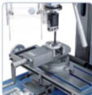
Si lo desea, la máquina se puede equipar con un cabezal de mandrinado.
