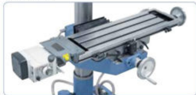
Gran mesa en cruz con ranuras en T y canales para recoger el refrigerante. Imagen con avance automático AL 450 D opcional
