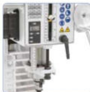
Pinola de grandes dimensiones con 125 mm de carrera, con indicador digital de serie
