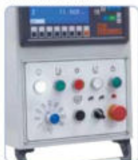
Ajuste rápido y fácil de la velocidad de avance deseada directamente en el panel de operación.
