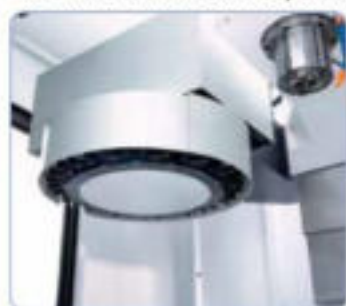
Cambiador automático de 16 herramientas con cambio rápido.
