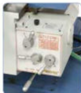
Gracias al avance de mesa de serie con función de marcha rápida en los 3 ejes se reducen significativamente los tiempos improductivos.
