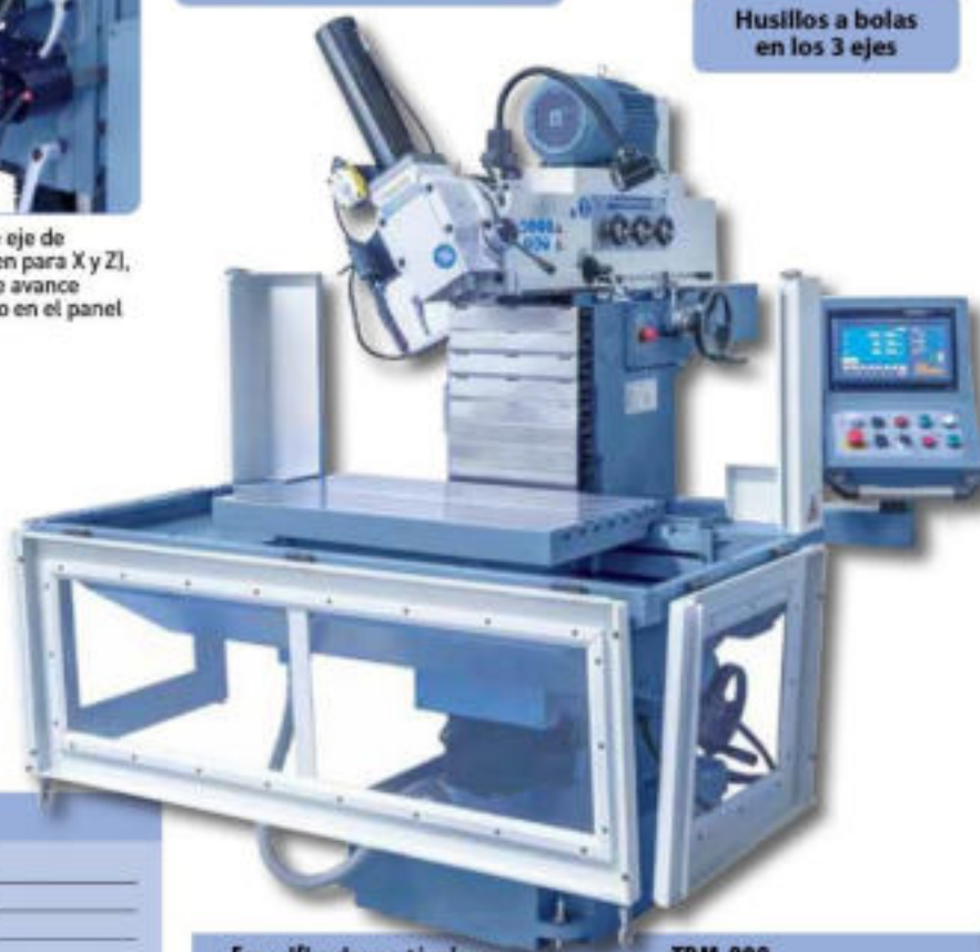
Elementos de control claramente dispuestos en la consola giratoria, de serie con visualizador de cotas LCD en 3 ejes
