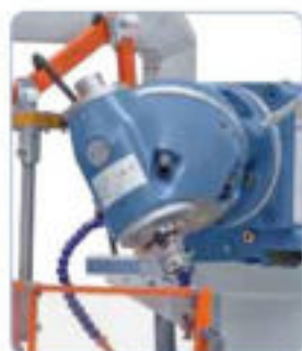
Cabezal portafresas universal ajustable en diferentes ángulos
