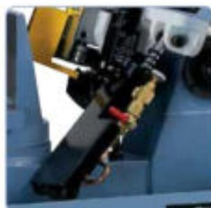
Para una bajada suave del arco de sierra dispone de un cilindro hidráulico incluido en el equipo base
