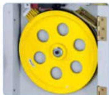
Los volantes equilibrados dinámicamente y de fundición gris garantizan un funcionamiento silencioso de la máquina.
