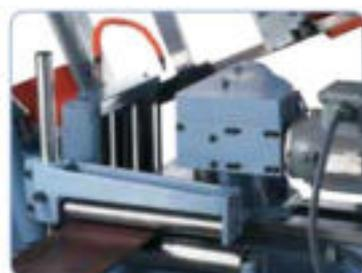
La mordaza está equipada de serie con rodillos accionados por un motor para el avance de las piezas a cortar.
