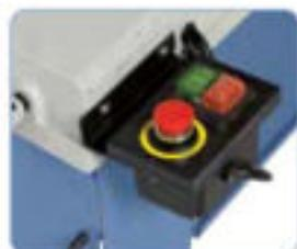
Interruptores de seguridad con desactivación en caso de caída de tensión y un botón de parada de emergencia independiente, desconexión final automática después de la finalización de proceso de corte
