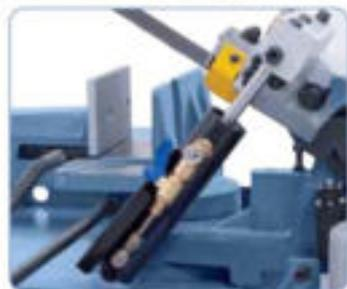
Cilindro hidráulico para un descenso suave del arco de sierra.
