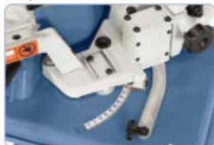
Arco de sierra ajustable para efectuar cortes a inglete
