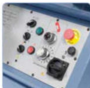
Ajuste cómodo de la velocidad de descenso mediante válvula de regulación.
