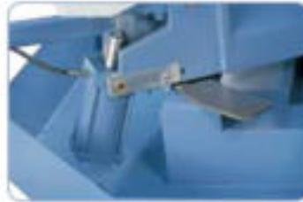
El cilindro hidráulico sujeta el arco de sierra sobre el ángulo de corte.
