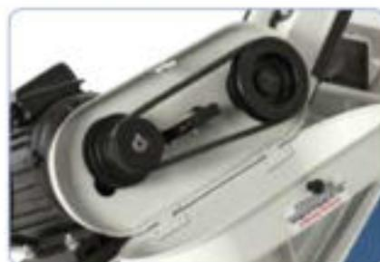
Mediante una correa trapezoidal puede cambiarse de forma rápida y sencilla la velocidad de la cinta.
