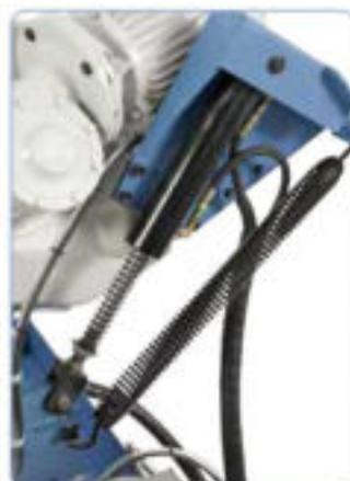
De serie con cilindro hidráulico para un descenso suave del arco de sierra.
