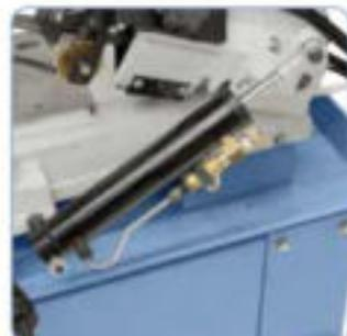
Cilindro hidráulico de grandes dimensiones para un descenso continuo del arco de sierra
