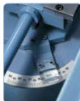
El ajuste del ángulo de corte deseado se lleva a cabo fácil y rápidamente mediante escala graduada.
