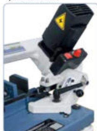
Motor con control de velocidad electrónico
