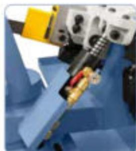
De serie con un cilindro hidráulico para una bajada continua del arco de sierra
