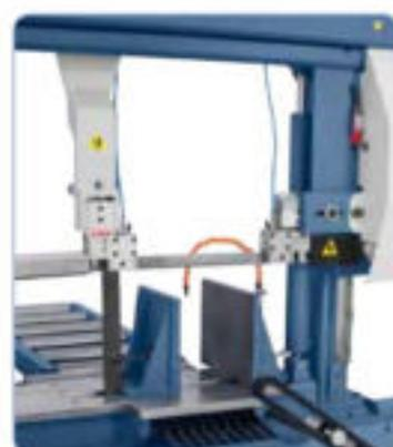
El guiado de cinta se puede adaptar de forma óptima al ancho de la pieza.
