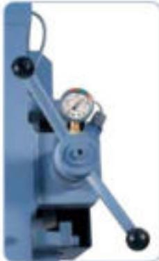
El ajuste exacto de la tensión de la cinta de la sierra se realiza mediante el manómetro incluido de serie.
