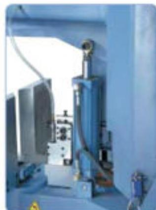
Se garantiza un descenso constante del arco de sierra mediante un robusto cilindro hidráulico.
