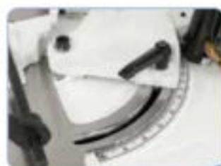
Arco de sierra giratorio para efectuar cortes a inglete doble de  $-45^\circ$  a  $+60^\circ$ .
