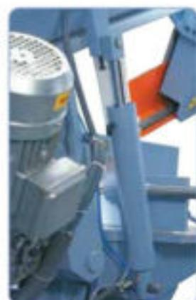
Para una bajada sensible del arco de sierra, dispone de un cilindro hidráulico.
