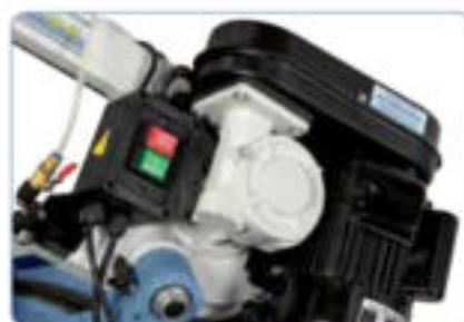
Mediante una correa trapezoidal puede cambiarse la velocidad de corte (23 / 33 / 52 m/min)
