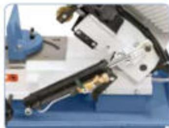
De serie con cilindro hidráulico para una bajada continua del arco de sierra.
