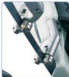
El guiado de la cinta con rodamientos a bolas y ajuste rápido para adaptarlo al ancho de la pieza de trabajo garantiza unos resultados óptimos.
