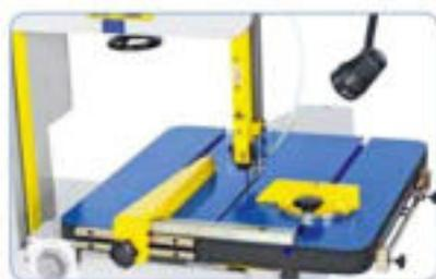
Guía paralela para cortes rectos y guía de inglete para cortes en ángulo.
