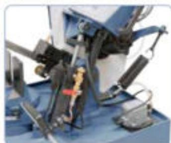
Cilindro hidráulico para un descenso continuo del arco de sierra.
