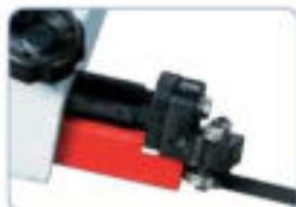
Guiado de la cinta de sierra con rodamientos a bolas, ajustable a cada uno de los anchos de la pieza de trabajo
