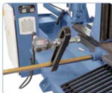
Preajuste manual de la longitud del material mediante microinterruptor, introducción y control de la cantidad de piezas en la consola de control
