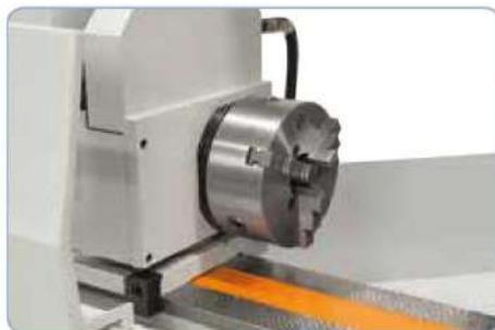
Para rectificadas cónicas el robusto cabezal puede girarse hasta 90°
