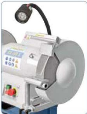
Sólido cuerpo de máquina con conexión de aspiración, protector contra chispas de grandes dimensiones y lámpara de máquina
