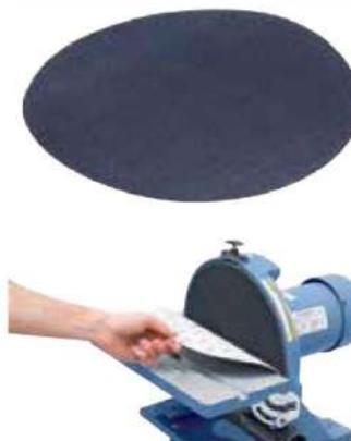
Los soportes de velcro son autoadhesivos en la parte posterior y se pegan en el disco de la lijadora. De esta forma se puede efectuar un cambio rápido entre los diferentes granos de abrasivos.
