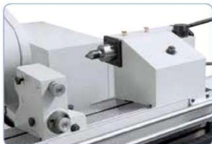
Contrapunto hidráulico con elevada precisión y estabilidad, desplazable mediante pedal
