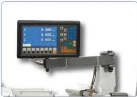
Completo con visualizador de cotas en 2 ejes para garantizar un trabajo adecuado y un aumento de la precisión.
