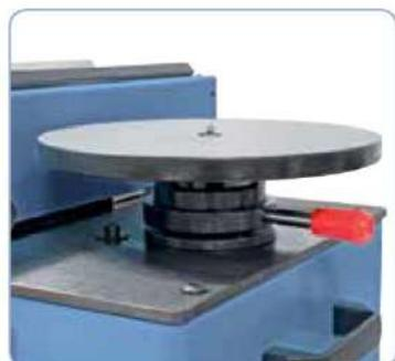
Ajuste rápido del ancho del chaflán durante el fresado de contornos con solo girar la plataforma giratoria.
