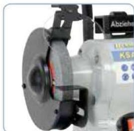
De serie con disco para desbaste, soporte ajustable de la pieza, protector lateral y ocular
