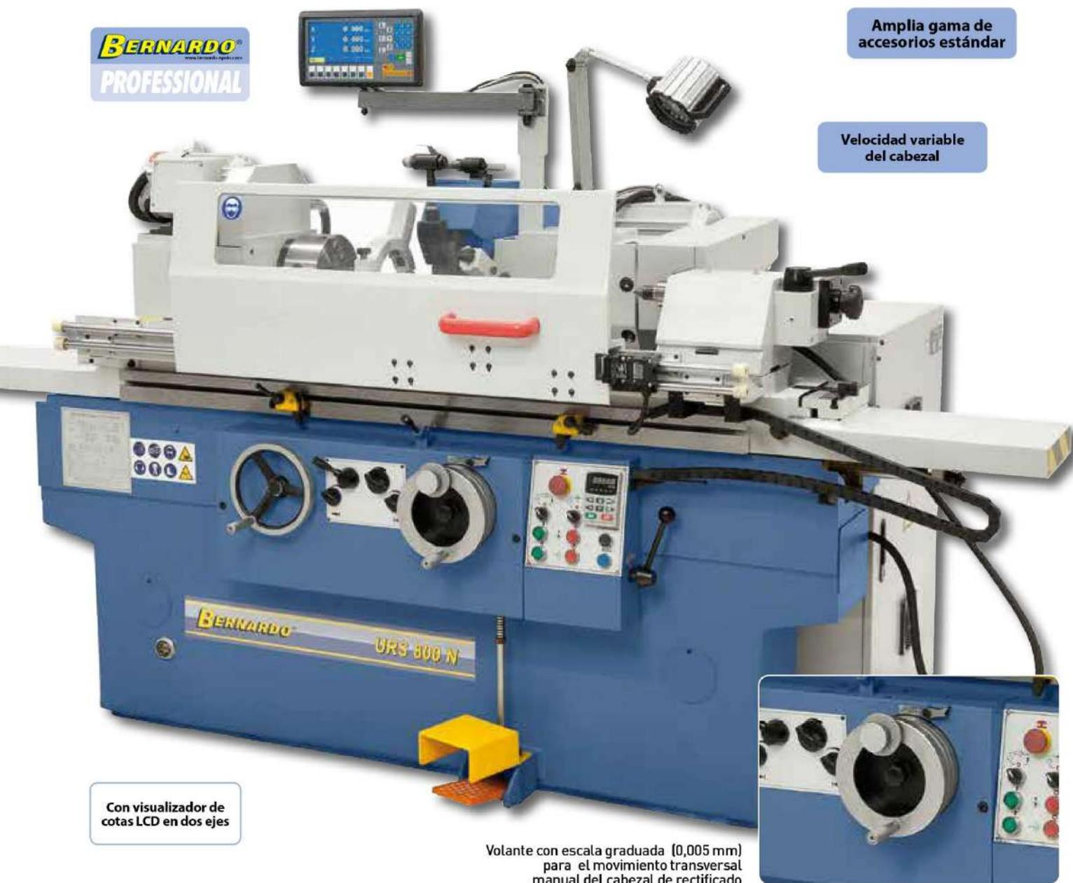
Con visualizador de cotas LCD en dos ejes
