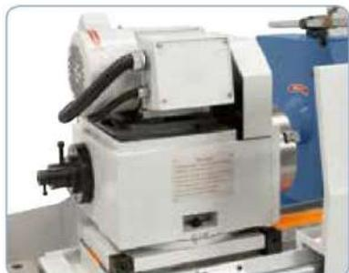
Cabezal giratorio entre 0° y 90° para rectificado cónico.
