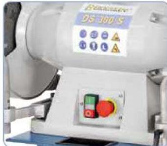
Botón de encendido y apagado con apagado en caso de caída de tensión y seta de emergencia
