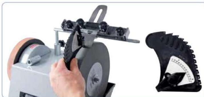
05-2051 Medidor de ángulos universal: para medir un ángulo existente o ajustar un ángulo de corte de 15° a 75°, apto para muelas de 150 a 250 mm de diámetro
