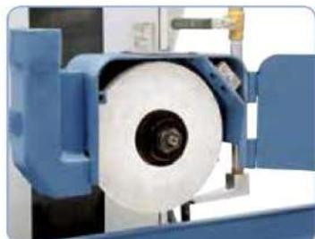
Funcionamiento con mínimas vibraciones y elevada precisión del husillo de rectificar mediante rodamientos pretensados.
