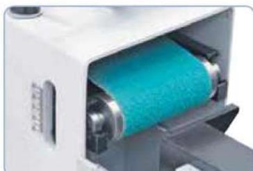
Ajuste en altura del rollo abrasivo para el lijado excéntrico
