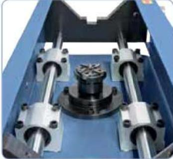
Resistente columna redonda para un desplazamiento uniforme de la guía
