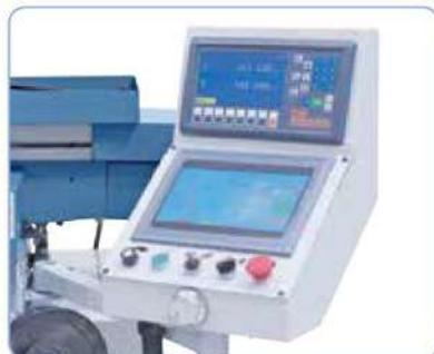
Control mediante pantalla táctil y volante electrónico.
