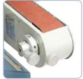
Tornillos de regulación que aseguran un ajuste adecuado del movimiento paralelo de la cinta.
