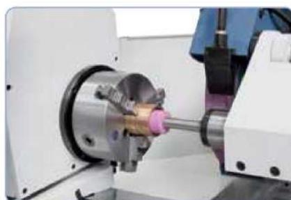
De serie con dispositivo de rectificado interior desmontable
