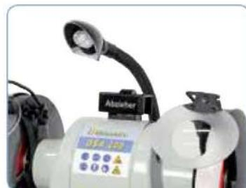
De serie con iluminación, diamantador de muelas y vidrio de protección con función lupa
